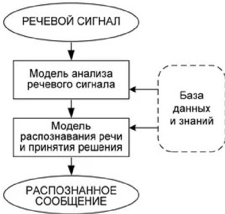
Структурная схема системы автоматического распознавания речи
